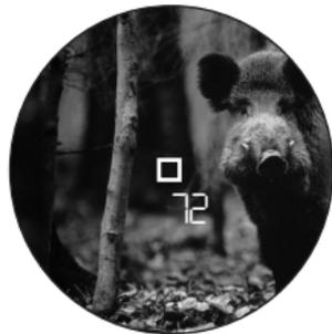
Con il Leica Rangemaster CRF 1000-R è possibile eseguire misurazioni anche a regime continuo (modalità Scan): premere il pulsante principale (2) e alla seconda selezione tenerlo premuto.
