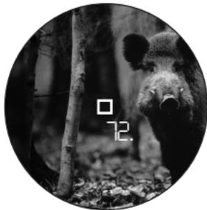
Le Leica Rangemaster CRF 1000-R permet également d'effectuer des mesures en continu (mode Scan): Maintenez la touche principale (2) enfoncée lors de la deuxième pression.
